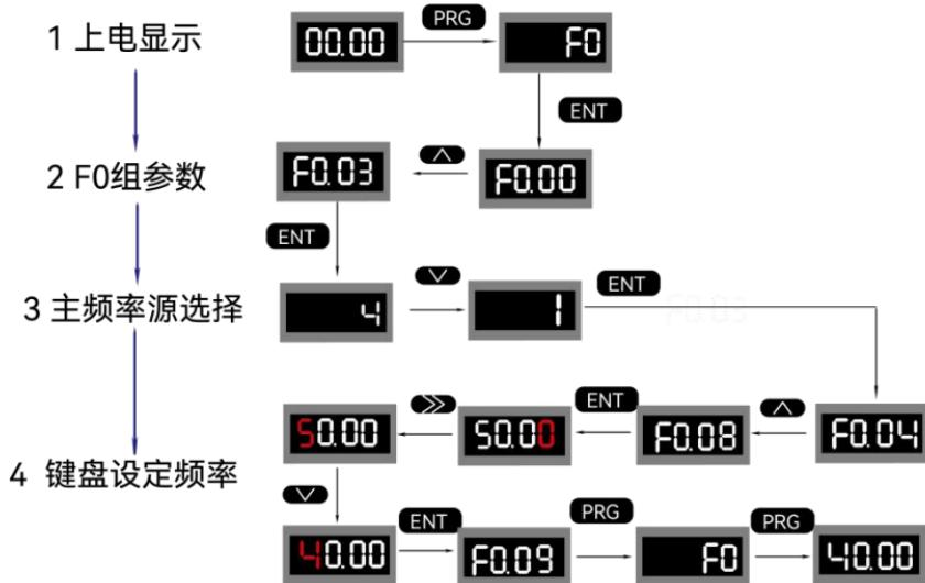
此流程图为初次上机设置过程，具体根据电机负载设置。
